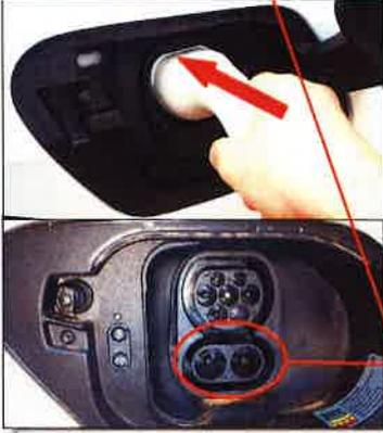
**Schließen Sie jetzt zuerst die Verbindung am Fahrzeug an**, anschließend am Ladepunkt (die Art des Anschlusses variiert je nach Ladesäule).
