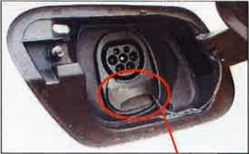
Klappen Sie hinten rechts die **Ladeklappe** auf. Drücken Sie dazu leicht oben links in der Ecke auf die Klappe, dann springt diese auf.
