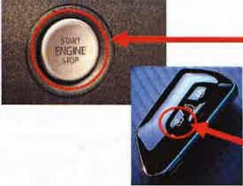
Schalten Sie die **Zündung** durch Drücken des **START-STOP-Knopf** rechts seitlich hinter dem Lenkrad **AUS** (in der Mitte der Instrumententafel erscheint wieder **PARK** anstelle von READY).
