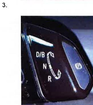
Bei getretenem Bremspedal können Sie nun durch Vor- oder Zurückdrehen des Wählschalters rechts oben hinter dem Lenkrad den Gang einlegen - statt PARK erscheint dann **READY**:
