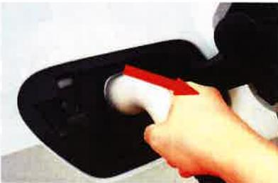
Lösen Sie zuerst die Verbindung hinten am Fahrzeug und anschließend am Ladepunkt:
